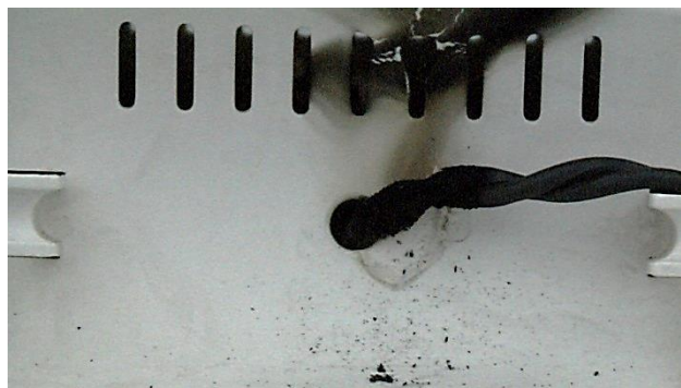
コードプロテクターを外したことで 屈曲して焼損した画像 (イメージ)
